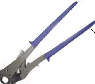
**E** Werkzeug erneut vollkommen schließen. Knickarm um eine weitere Stufe nach außen ziehen und erneut schließen. Vorgang wiederholen bis letztendlich die Zwangssperre entriegelt und den Fitting zur Entnahme freigibt.
